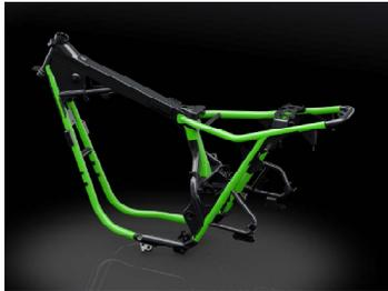
Double-cradle frame (frame dudukan ganda) pada motor ini terlihat tidak berubah dari pendahulunya, meskipun telah diperbaharui. Tingkat rigid yang dibutuhkan pada setiap juga bagian telah dievaluasi. Diameter pipa luar tidak berubah, namun ketebalan pipa disesuaikan sesuai kebutuhan. Frame dudukan ganda dibuat kokoh dengan backbone sebesar 50 mm persegi, yang memberikan kestabilan dan keseimbangan.
